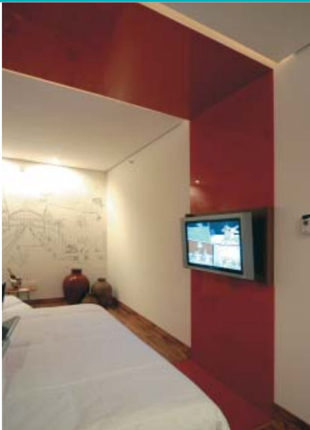
Suíte 304: com um toque todo especial obtido por meio do vidro serigrafado laranja, fornecido e executado pela Edu Vidros, a designer Viviane Dinamarco arriscou e envolveu a suíte com uma faixa envidraçada aplicada no teto, paredes laterais (4 mm) e piso (8 mm)
