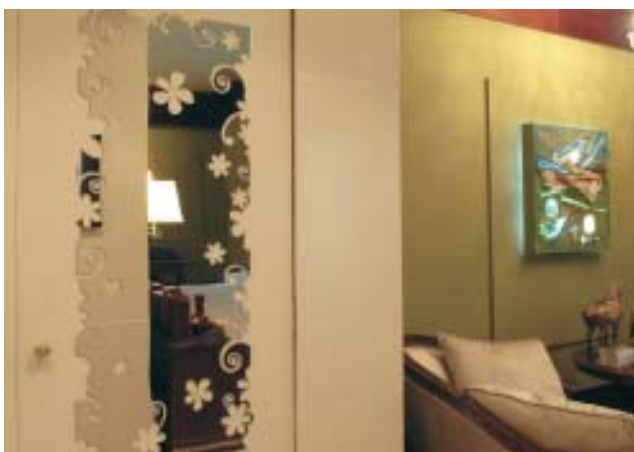
Suíte 404: o recorte artesanal do espelho de 1,20 x 0,45 cm (8 mm), feito pelo Atelier de Ana Paula Castro para o arquiteto Sérgio Paulo Rabello, já anuncia a sofisticação do ambiente. O material foi colado com fita dupla face na porta do armário
