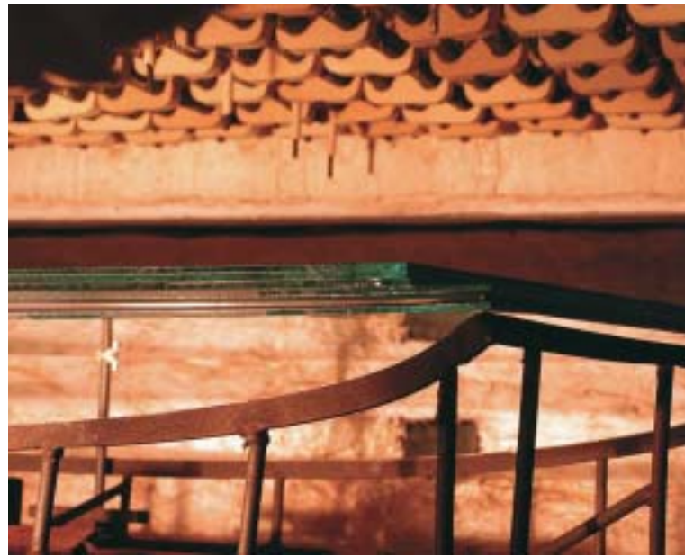
630 graus: vidro blindado visto de dentro do forno durante processo de curvação
