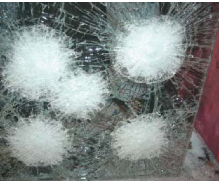
Corpo de prova: blindado (23 mm) laminado com resina Uvekol S 20 atingido por projéteis de Magnum 44
