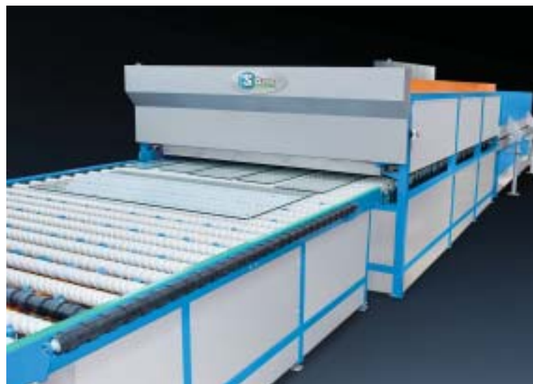
SGlass: empresa desenvolve forno horizontal de 2,6 m de largura por 5 m de comprimento. O modelo será o maior fabricado no Brasil
