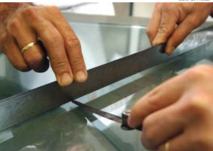
Régua metálica mede o grau de empenamento do temperado. Tolerância é de até 0,003 mm
