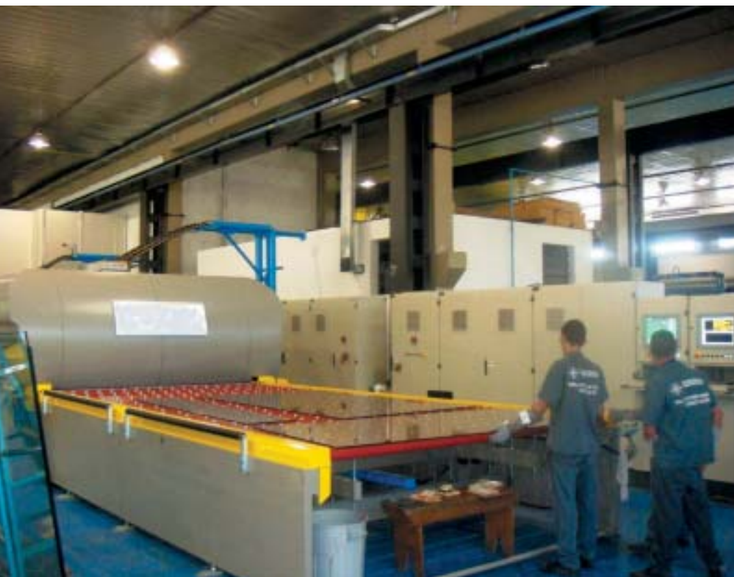
Novo forno da Divinal tempera peças de até 5,2 x 2,6 m
