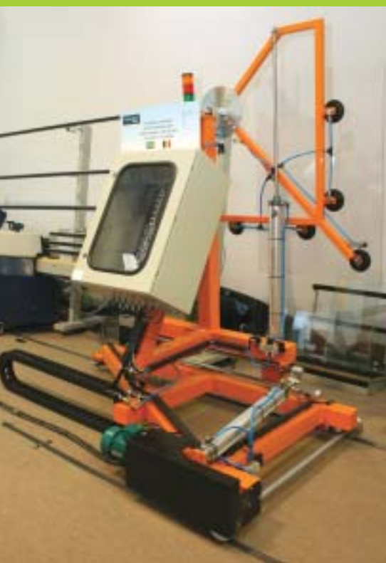
Robô: projetado para transportar vidros entre máquinas laminadoras
