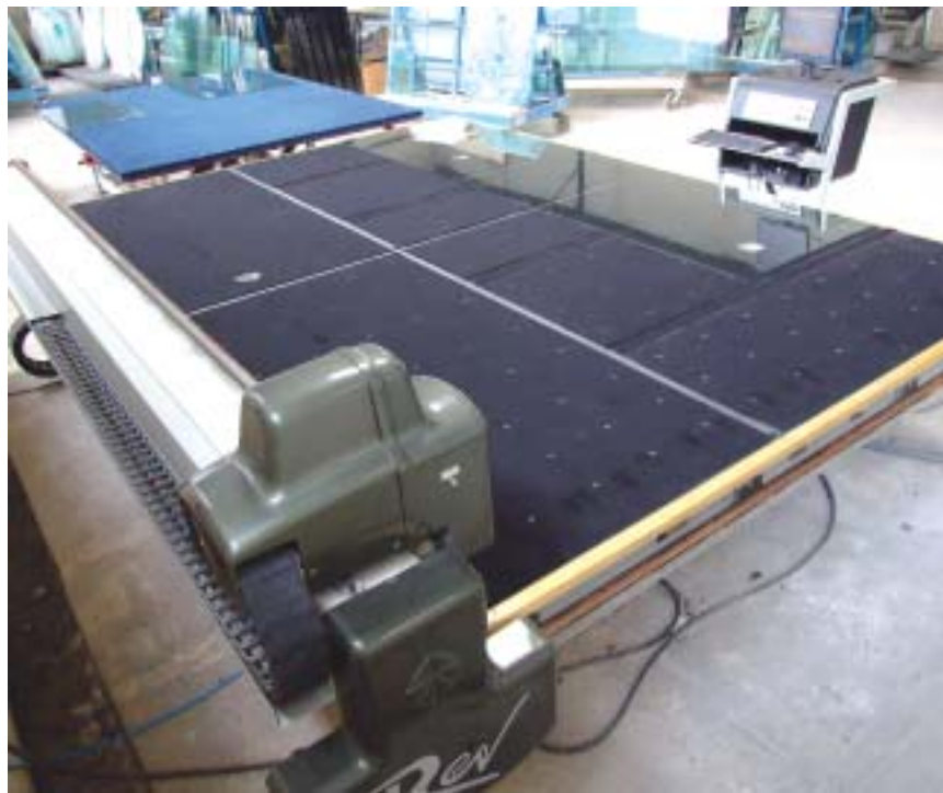
Mesa de corte automática na planta da Glassmaxi: vidros temperados estão certificados pelo Inmetro/IFBQ
