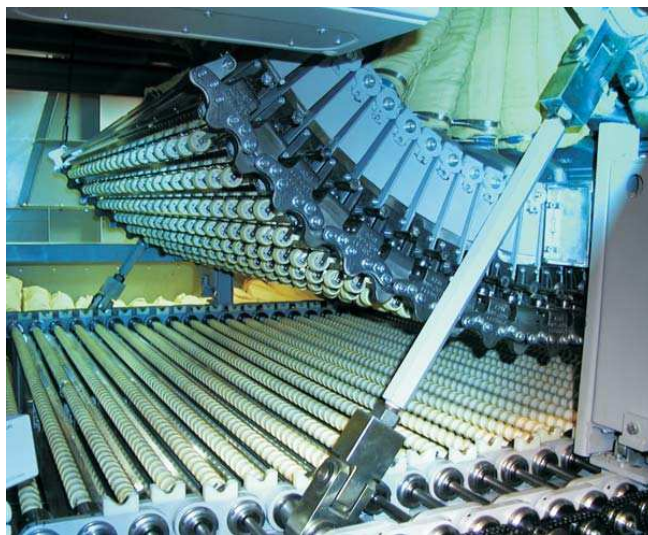
Sem ferramental: forno da Tamglass possui roldanas que curvam e temperam conforme o comando do computador
