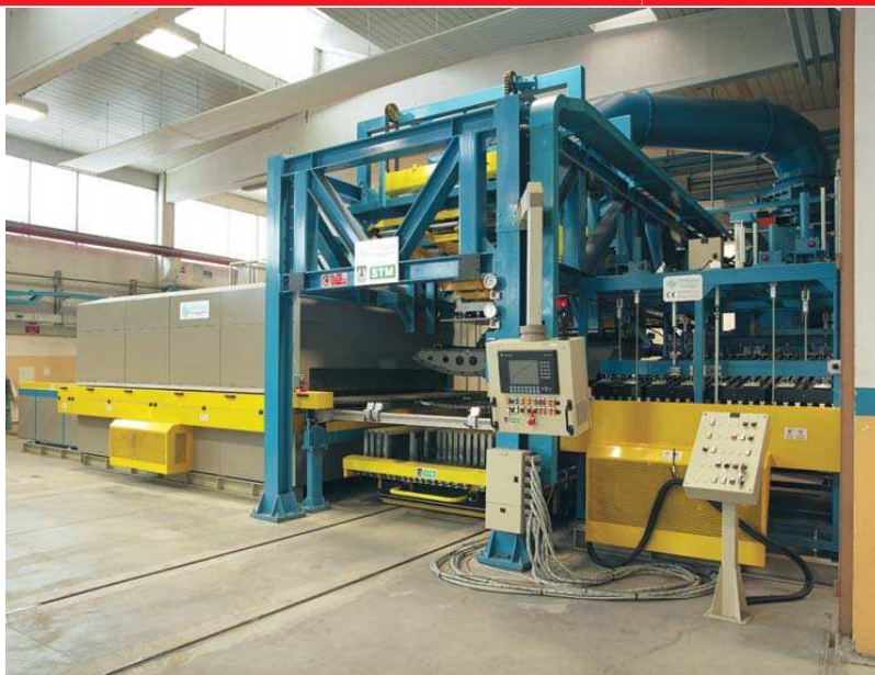
Equipamento da Keraglass: sistema de curvatura da empresa impede o contato do vidro com os rolos em momento crítico do processo
