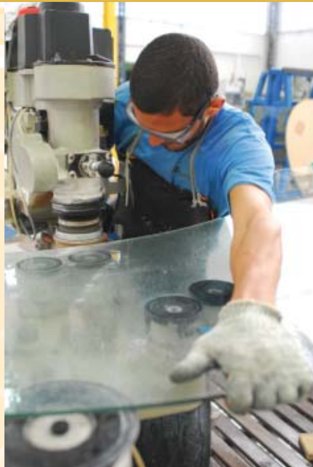
Operador manuseia vidro em máquina para lapidar peças redondas ou modeladas em curvas
